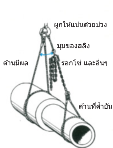
รูปภาพ 5-22 การขึงสลิงโดยปรับให้เข้ากับอุปกรณ์ชักรอก อื่น: ด้านมีผล: การขึงสลิงแบบหมุนหนึ่งรอบ
