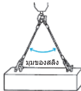
รูปภาพ 3-4 มุมของสลิงสำหรับวิธีการขึงสลิงโดยใช้ลวดสองเส้นและจุดสองจุด
