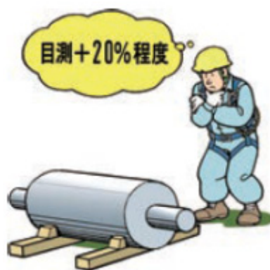
รูปภาพ 5-2 ประเมินน้ำหนักของน้ำหนักบรรทุกด้วยสายตา
