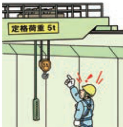
รูปภาพ 5-1 ภาพตัวอย่างแสดงน้ำหนักบรรทุกที่กำหนดของเครนเหนือศีรษะ
