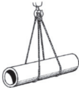
รูปภาพ 2-27 การชั่งสลิงแบบหมุนครั้งเดียวพร้อมกับโหลดสองเส้นและจุดสี่จุด
