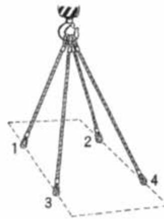
**Imagem 5-15** A direção longitudinal é perpendicular à direção do gancho (1-3-2-4 ou 3-1-4-2 da extremidade do gancho)
