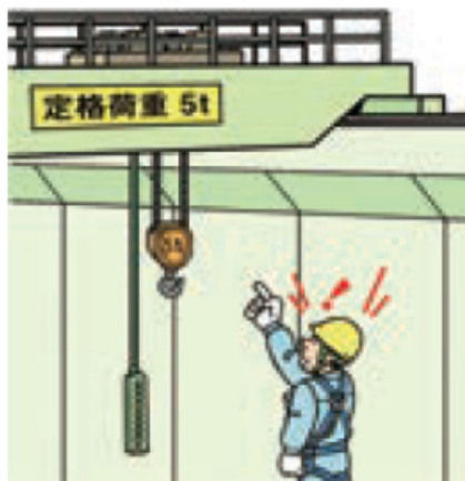
चित्र 5-1 ओभरहेड ट्रामेलिड क्रेनमा रेटेड लोडको उदाहरणको डिस्ले
