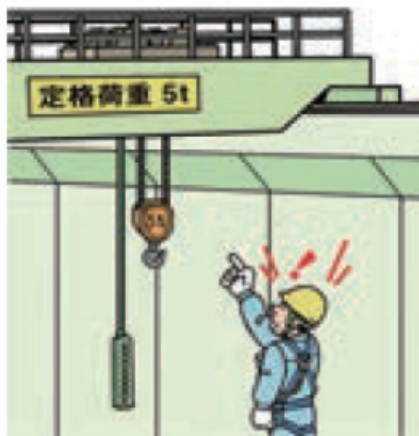
그림 5-1 천장 크레인의 정격 하중 예 표시
