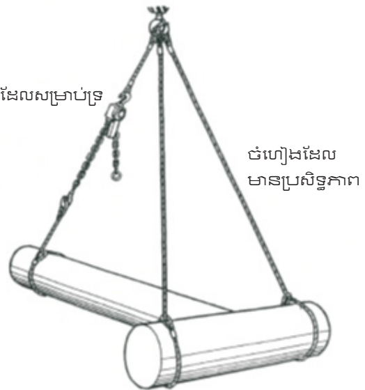
រូបភាព 5-23 ការចងខ្សែស្លូតដែលត្រូវបានលៃតម្រូវដោយគ្រឿងបន្លាស់បន្ទុកសម្រាប់យោងស្លូតមួយផ្សេងទៀត៖ ចំហៀងដែលមានប្រសិទ្ធភាព៖ ការចងដោយរង្វង់កំណាចខ្សែ
