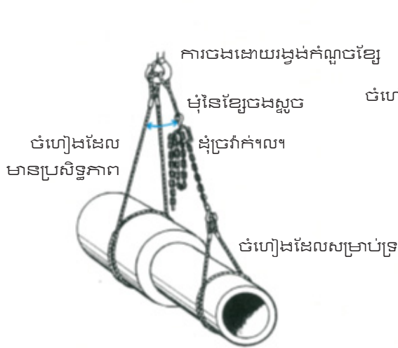
រូបភាព 5-22 ការចងខ្សែស្លូតដែលត្រូវបានលៃតម្រូវដោយគ្រឿងបន្លាស់បន្ទុកសម្រាប់យោងស្លូតមួយផ្សេងទៀត៖ ចំហៀងដែលមានប្រសិទ្ធភាព៖ ការចងខ្សែស្លូតដោយចងក្នុងជុំវិញតែមួយជុំ
