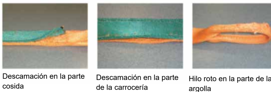
Fig. 3-31 Descamación en el cinturón
