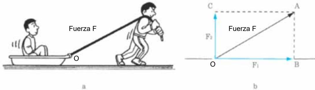
Fig. 2-2 Descomposición de las fuerzas
