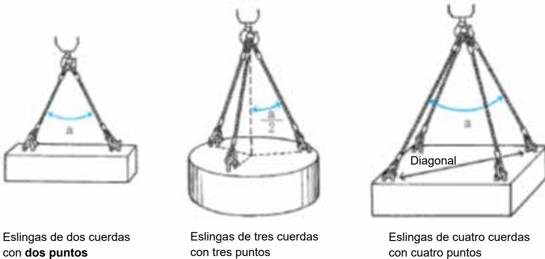
Fig. 2-24 Número de cuerdas y ángulo de la eslinga ( a = ángulo de la eslinga)
