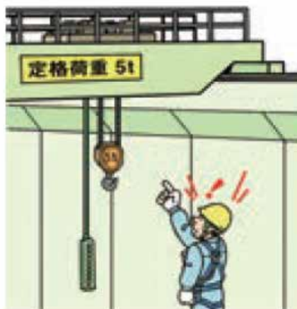
Fig. 5-1 Ejemplo de carga nominal en la grúa de transporte aéreo
