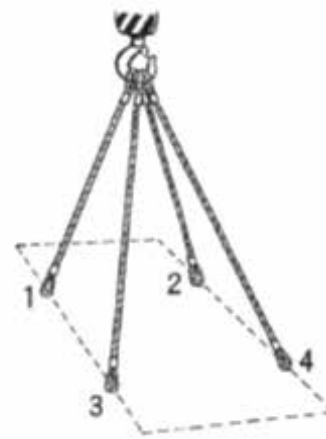
Fig. 5-15 La dirección longitudinal es perpendicular a la dirección del gancho (1-3-2-4 o 3-1-4-2 desde el extremo del gancho)
