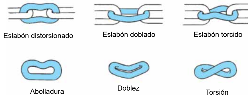
Fig. 3-29 Deformación de la cadena
