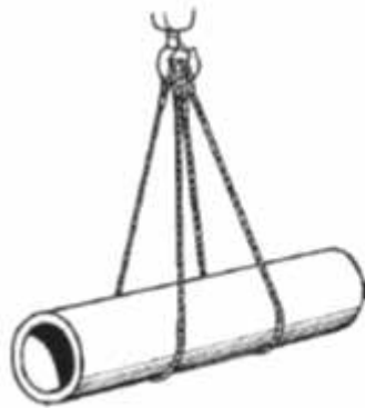
Fig. 2-27 Eslinga de una sola vuelta con dos cuerdas y cuatro puntos
