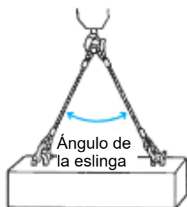
Fig. 3-4 Ángulo de la eslinga para eslingas de dos cuerdas con dos puntos
