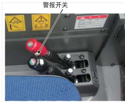
图 1-55 越野起重机报警装置（示例）
