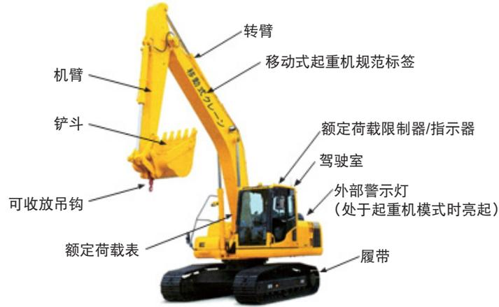
图 1-14 带起重机功能的液压挖掘机
