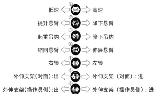
图 1-61 卡车装载起重机的直接控制方法操纵杆（示例）
