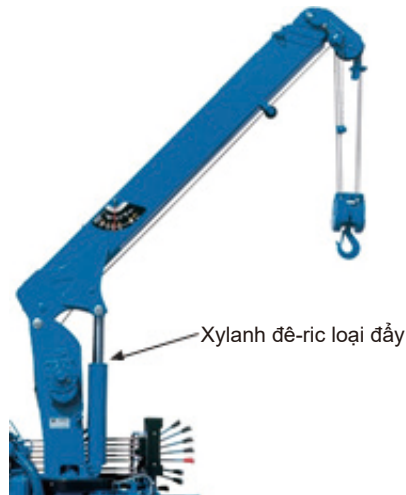
Hình. 1-40 Cơ cấu Thao tác Đê-ric Sử dụng Xylanh Thủy lực
