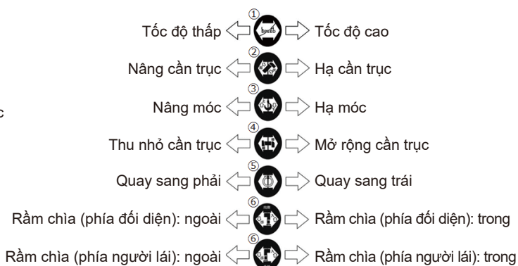
Hình. 1-61 Phương pháp Điều khiển Trực tiếp Cần Điều khiển cho Cần cẩu Gấp (Ví dụ)
