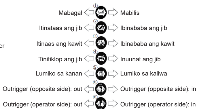
Figura 1-61 Mga Direct Control Method na Pangkontrol na lever para sa Crane na Trak Loader (Halimbawa)
