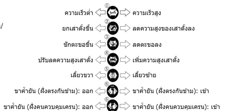
รูปภาพ 1-61 คันโยกควบคุมสำหรับวิธีการควบคุมโดยตรงในเครนดิรรถบรรทุก (ตัวอย่าง)
