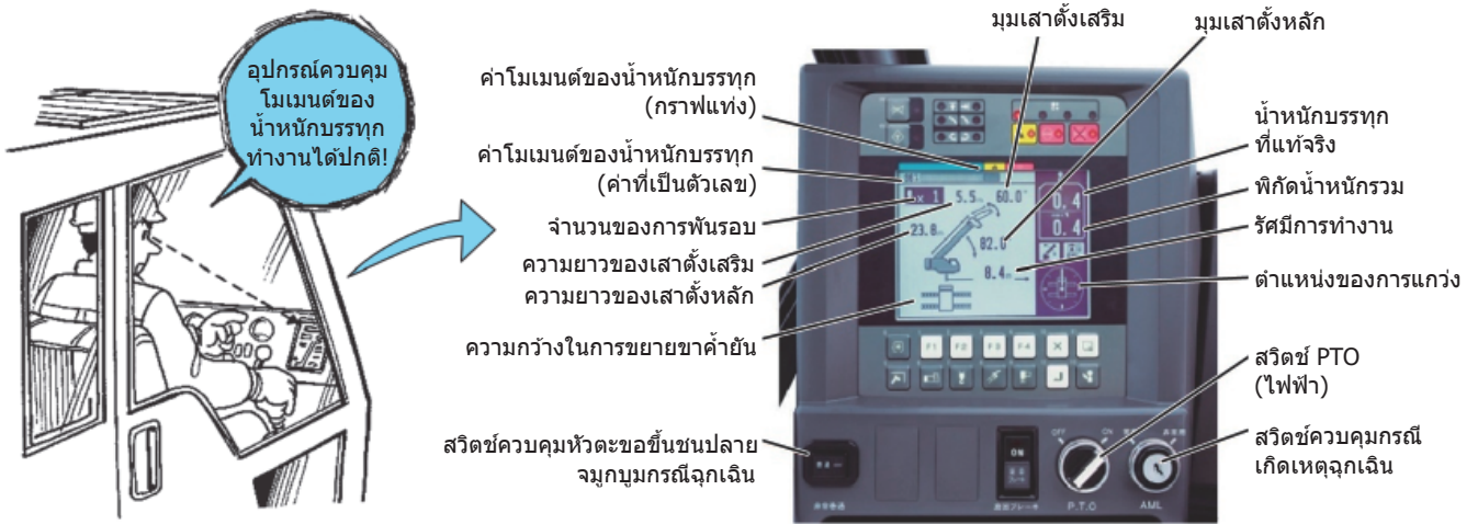
รูปภาพ 1-82 ตัวอย่างการแสดงผลของอุปกรณ์จำกัดโมเมนต์ของน้ำหนักบรรทุก (รถเครนแบบرافเตอเร็นหรือเครนสี่ล้อ)
