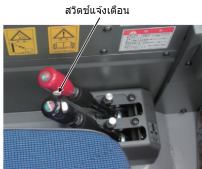
รูปภาพ 1-55 อุปกรณ์เตือนของรถเครนแบบราฟเตอเร็นหรือเครนสไลล์ (ตัวอย่าง)
