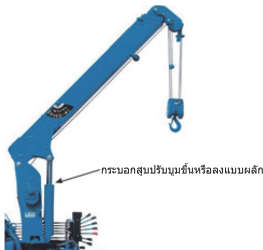
รูปภาพ 1-40 กลไกการปรับมุมขึ้นหรือลงที่ใช้กระบอกลูกสูบไฮดรอลิก
