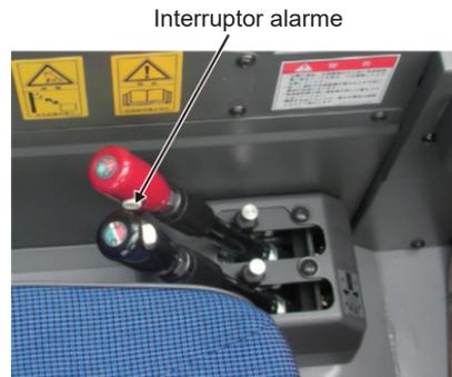
Fig. 1-55 Dispositivo de alerta de grua de terreno instável (exemplo)
