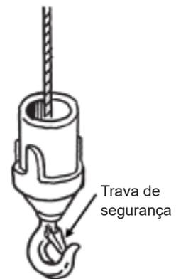
Fig. 1-44 Gancho de içamento auxiliar
