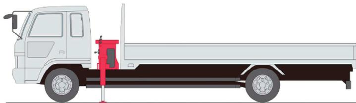
Fig. 1-22 Transportadora base da grua carregadora de caminhão
