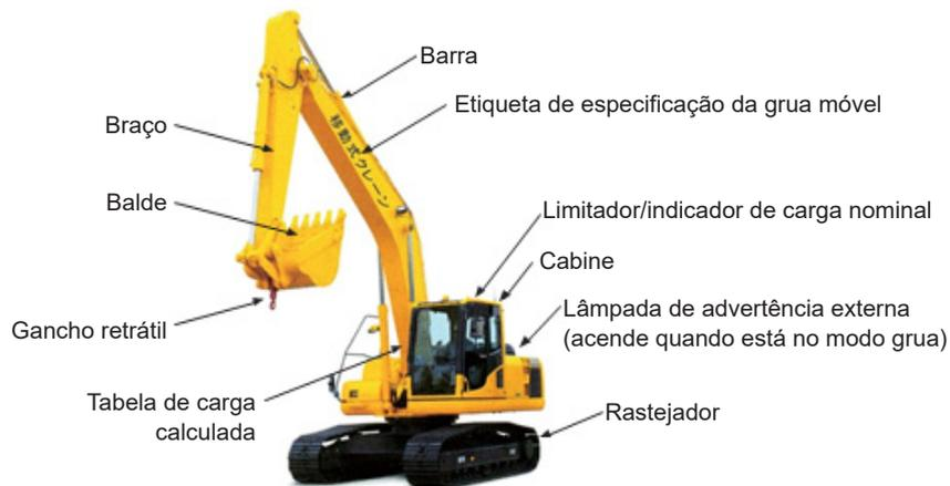
Fig. 1-14 Escavadeira hidráulica com função de grua
