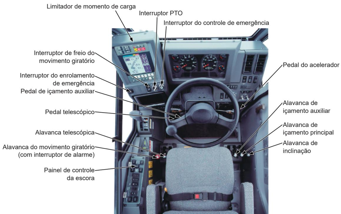
Fig. 1-58 Arranjo de dispositivos de operação em cabine da grua de terreno instável (Exemplo)
