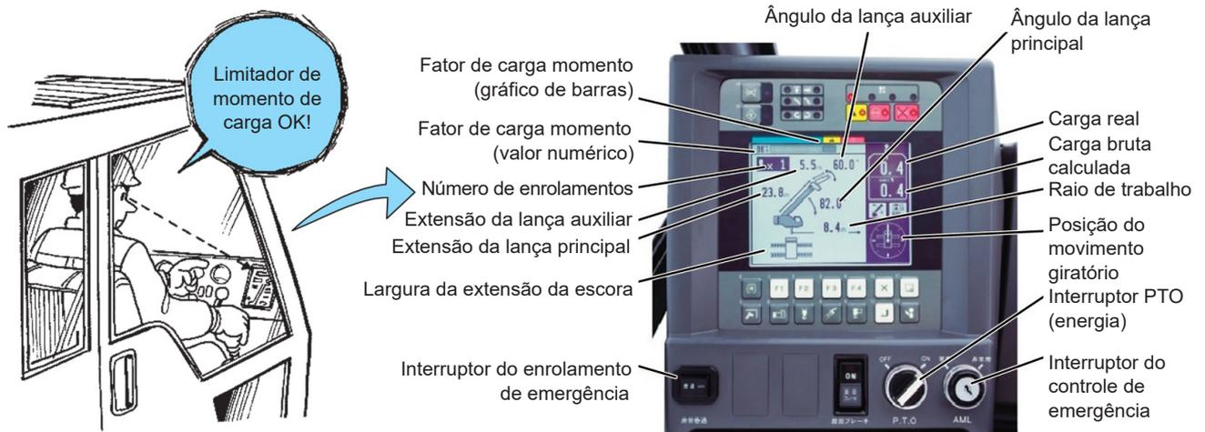
Fig. 1-82 Exemplo de exibição do limitador de momento de carga (grua de terreno instável)
