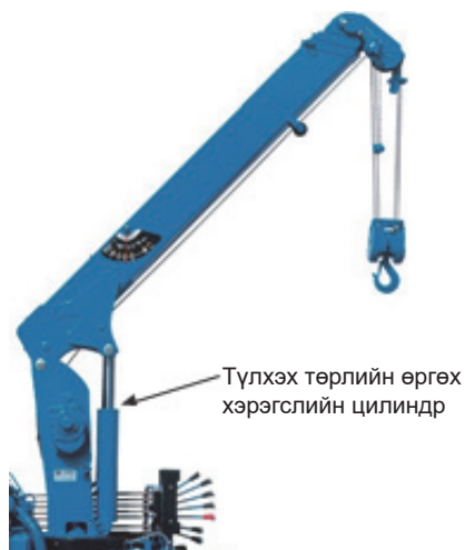
Зур. 1-40 Гидравлик цилиндр ашигладаг өргөх механизм
