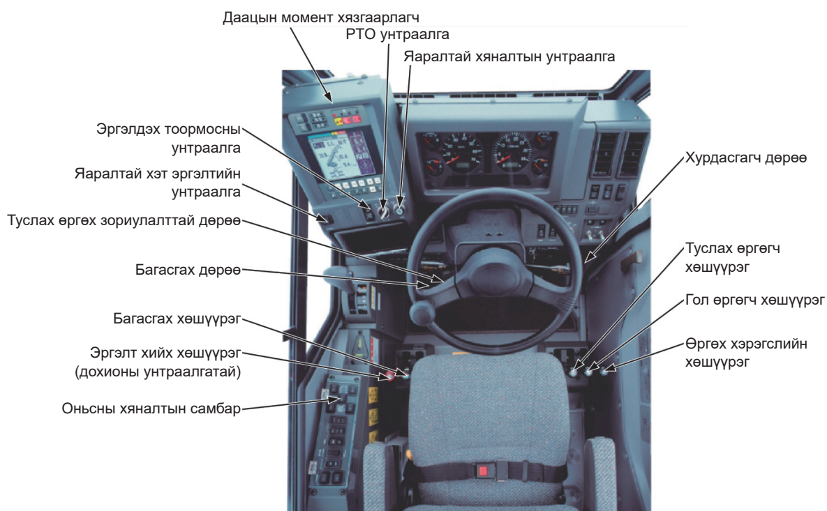
Зур. 1-58 Хийн дугуйтай краны кабин дахь ажиллуулах төхөөрөмжийн зохицуулалт (Жишээ)
