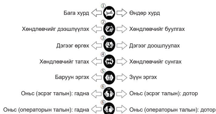
Зур. 1-61 Авто ачигчтай кранд зориулсан шууд хяналтын аргын хяналтын хөшүүрэг (Жишээ)
