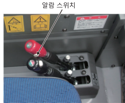
그림 1-55 협지형 크레인 경고 장치(예)
