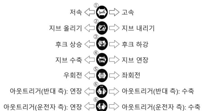
그림 1-61 트럭 로더 크레인의 직접 제어 방식 제어 레버(예)
