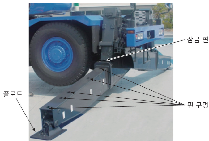
그림 1-26 X형 아웃트리거 잠금 핀 및 핀 구멍
