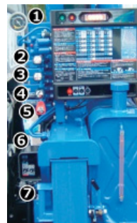
រូបភាព 1-19 ឧទាហរណ៍នៃកុងតាក់/ឃ្លាស់សម្រាប់បញ្ជាគ្រប់គ្រងរបស់ម៉ាស៊ីនស្លូតសម្រាប់ផ្ទុកបន្ទុកប្រភេទឡានទ្រុង
