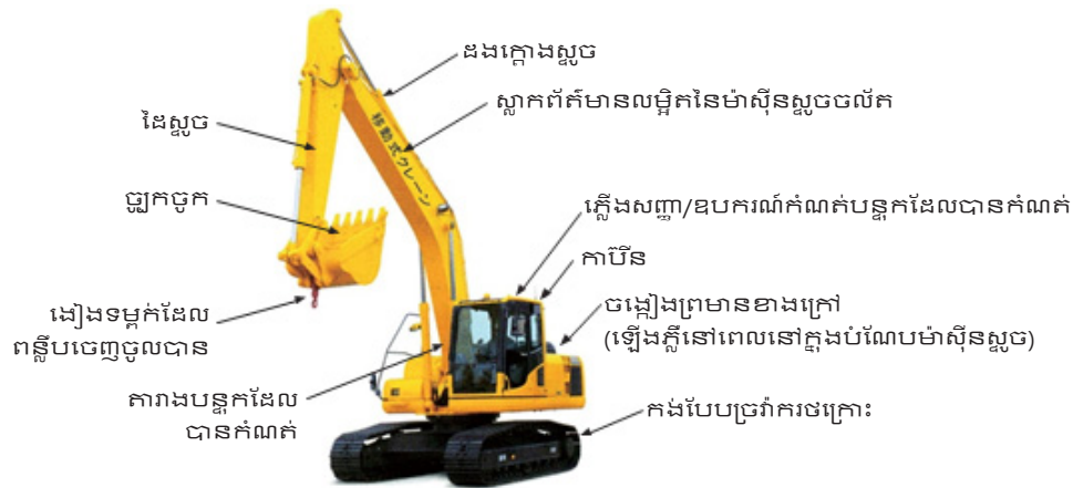
រូបភាព 1-14 គ្រឿងចក្រកាយដីដើរដោយអ៊ីដ្រូលីកដែលមានមុខងារដងស្ទូច
