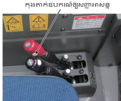
រូបភាព 1-55 ឧបករណ៍ព្រមានម៉ាស៊ីនស្អាតសម្រាប់ភូមិសាស្ត្រដីរដិបរដុប (ឧទាហរណ៍)
