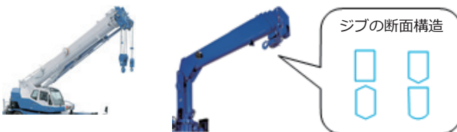
図1-20 箱型構造ジブ
