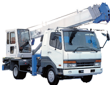
図1-7 トラッククレーン
