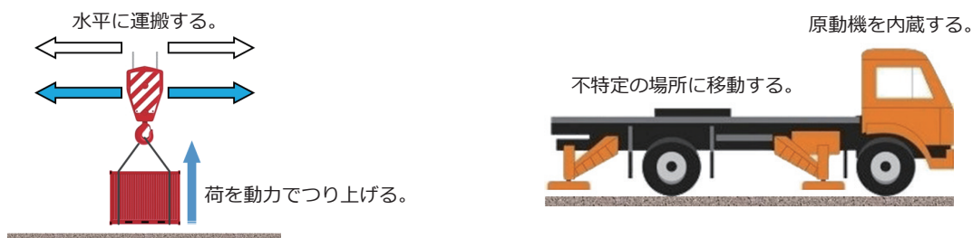
図1-1 移動式クレーンの定義
