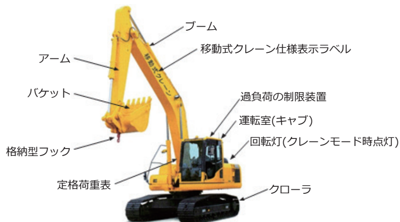
図1-14 クレーン機能付き油圧ショベル
