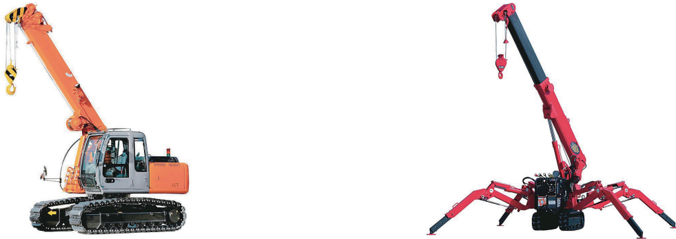
図1-11 小型クローラクレーン
