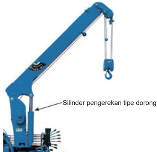
Gbr. 1-40 Mekanisme Pengerekan yang Menggunakan Silinder Hidrolik
