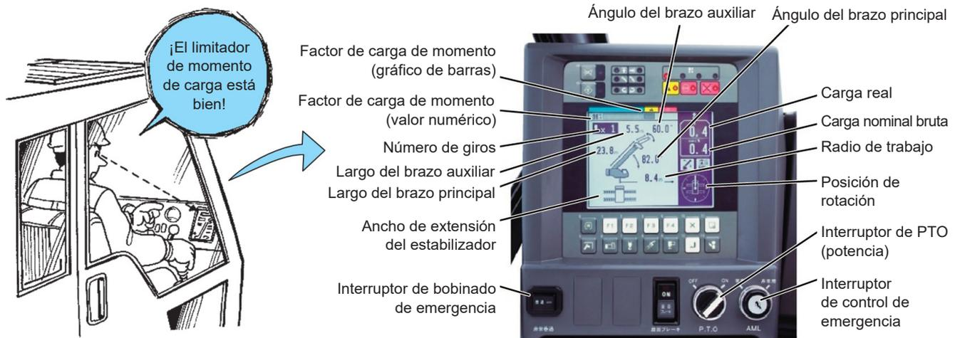
Figura 1-82 Ejemplo de pantalla del limitador de momento de carga (grúa todo terreno árido)
