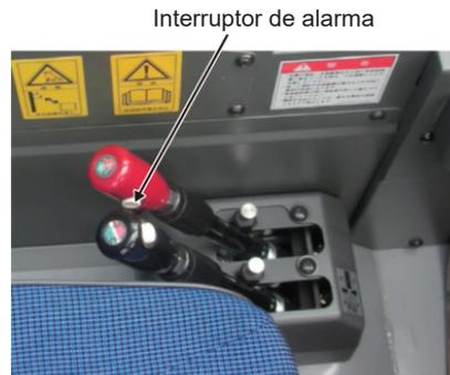
Figura 1-55 Dispositivo de advertencia de la grúa todo terreno árido (ejemplo)
