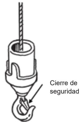
Figura 1-44 Gancho de elevación auxiliar
