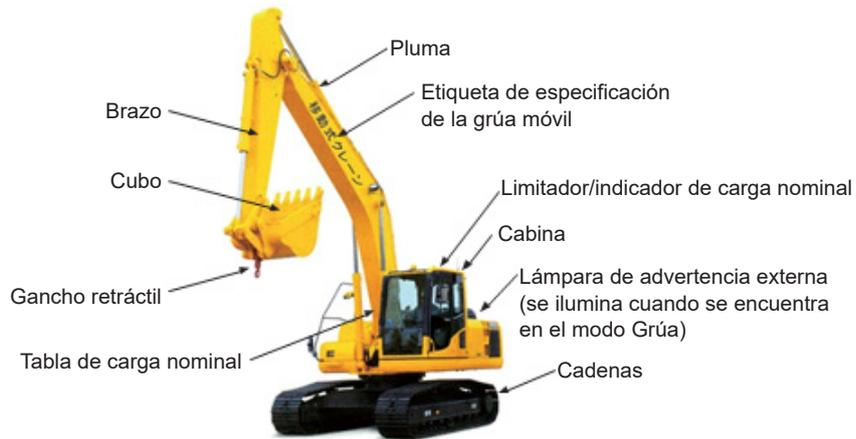
Figura 1-14 Excavadora hidráulica con función de grúa
