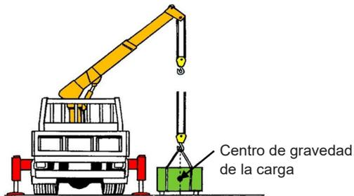
Figura 1-79 Posición del gancho al levantar
