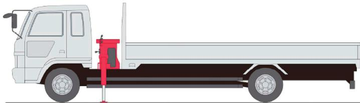
Figura 1-22 Soporte base de camiones grúa de carga
