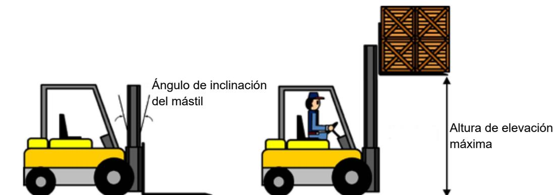
**Figura 1-3** Ángulo de inclinación del mástil y altura de elevación máxima
