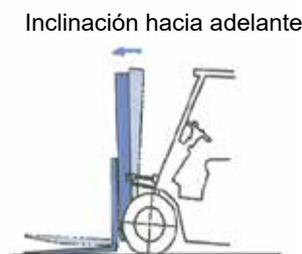
**Figura 3-9** Inclinación del mástil hacia adelante
