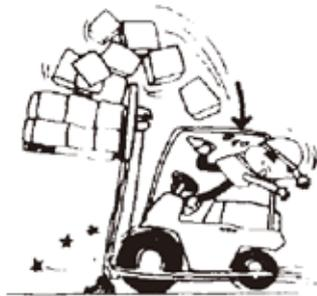
**Figura 5-4** No conducir con una carga elevada
