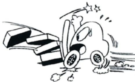
Figura 8-23 Fuerza de inercia del montacargas
