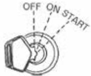
**Figura 3-1** Interruptor de arranque sin posición de precalentamiento
