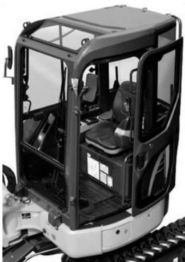
ภาพถ่ายที่ 3-9 เครื่องจักรก่อสร้างประเภทยานพาหนะที่มีโครงสร้างป้องกันเวลาพลิกคว่ำ
