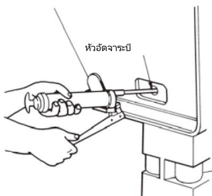
ภาพที่ 5-3 ตัวอย่างการอัดจาระบีด้วยปืนอัดจาระบี
