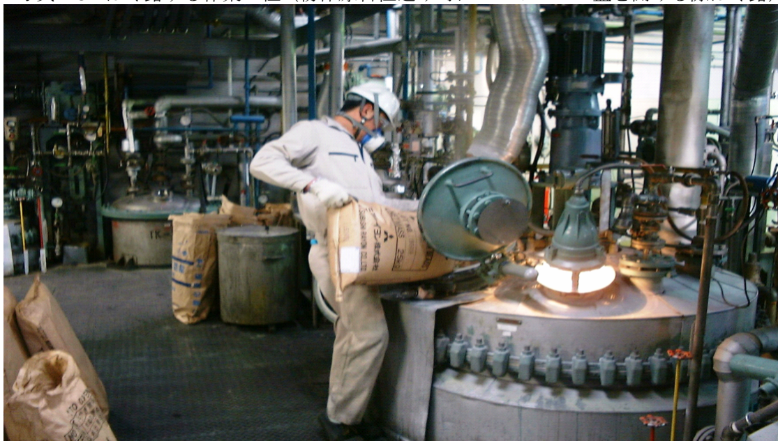
写真－3：ばく露する作業工程（粉体原料仕込み時にマンホールの蓋を開ける際ばく露）
