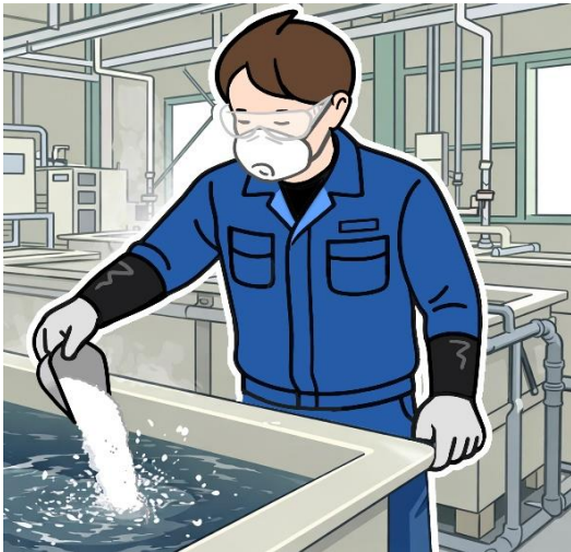
図は防じんマスク、保護手袋、保護めがね着用例 （化学物質の性状により、防毒マスクが必要な場合もある）
