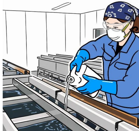
図は防じんマスク、保護手袋、保護めがね着用 （化学物質の性状により、防毒マスクが必要な場合もある）
