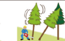
（図4）かかり木に激突させるためにかかり木以外の立木の伐倒
