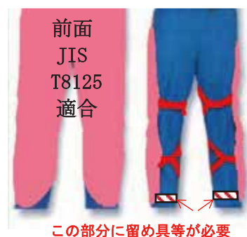
図 2.6 規則に適合するチャップスの条件
