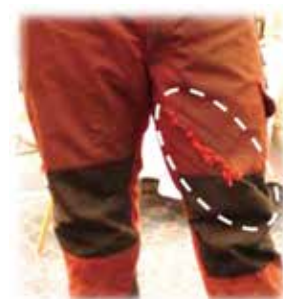
写真 2.4 使用してはいけな防護ズボン
