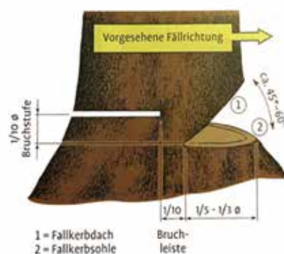
図 2.19 ドイツの伐木技術 出典：Der Forstwirt
