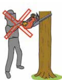
図 2.13 チェーンソーを肩より高く上げて作業は禁止
