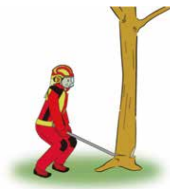
図 2.25 小径木のフェリングレバー伐倒
