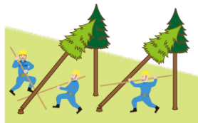
(図2)かかり木の処理
