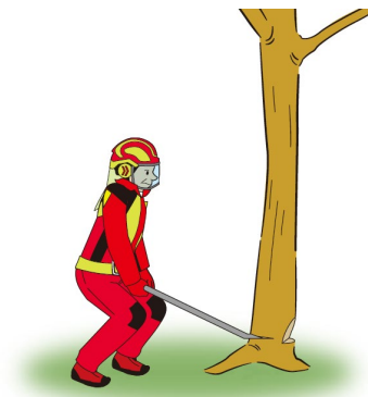
図 2.21 小径木のフェリングレバー伐倒
