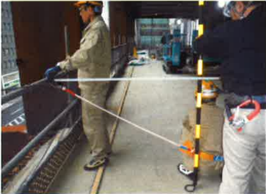
(ランヤード1.5mでの実証: 床面作業)
