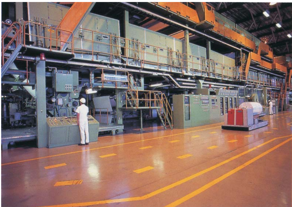
図2 サーマルペーパー塗布工程 写真
