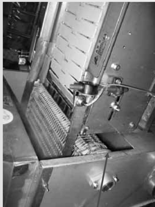
ネットコンベア入口 出口
