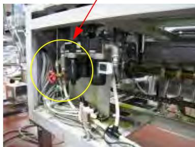
※残圧抜きバルブはアクセスパネルで塞がれた本体下部にあり、容易に残圧抜きが出来ない位置にある
