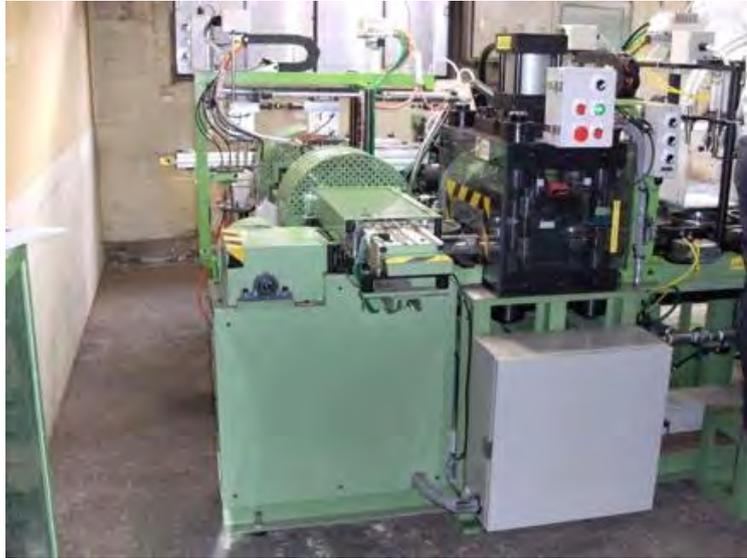
写真6 砥石自動成型ライン（保護方策実施後）
