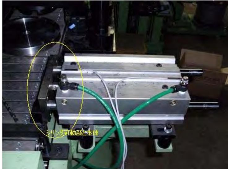
写真3 金型押出機構
