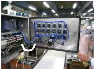
(12) 操作盤の扉の主回路電源遮断器
