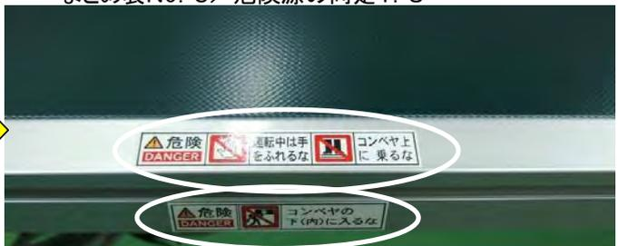
フレーム中央部・上面に「コンベヤ上に乗るな」、側面に「コンベヤの下に入るな」シールを貼り付けた。
