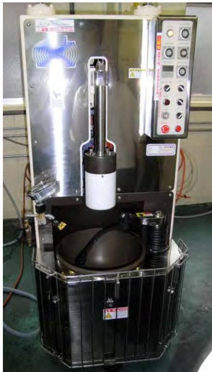
写真1 D社クランク式自動餅搗機
