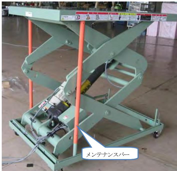
写真2 電動式リフト用メンテナンスバー
