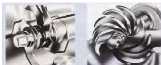
図2. 回転刃と刃の取付け機構
