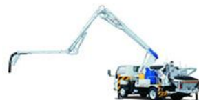
コンクリートポンプ車(※7)
