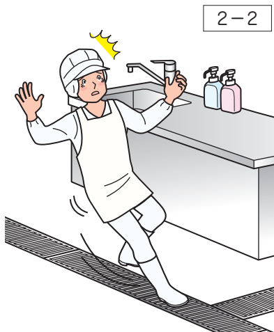
グレーチングで、転倒の危険
