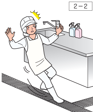
グレーチングで、転倒の危険
