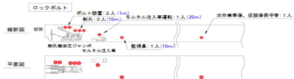
■トンネル掘削における人員構成配置と掘削サイクル（平均3サイクル/日、CⅡ・DⅠパターン相当）
