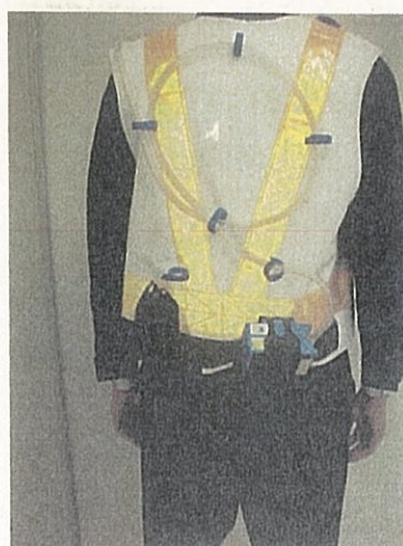
写真9 分粒装置と相対濃度計を組合せたサンプリング装置装着例
