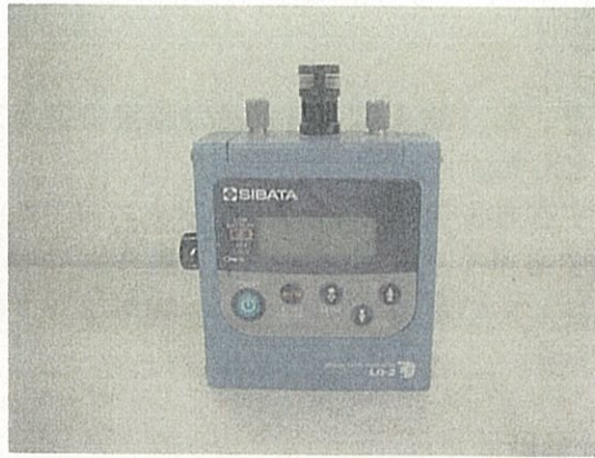
写真5 相対濃度計 (LD-2 型) の概観
