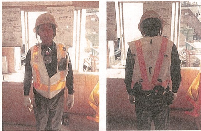
写真 10 10mmナイロン Dorr Oliver サイクロン付きサンプラーと LD-2 型粉じん計を接続したときの装着写真
