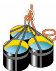
屋根の手前側（昇降側）の連結方法
