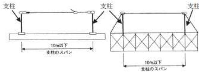
イ 支柱のスパン（L）は、支柱を設置した作業床と、衝突のおそれのある床面又は機械設備等との垂直距離（H）に応じ次式により算出した値以下であること。
