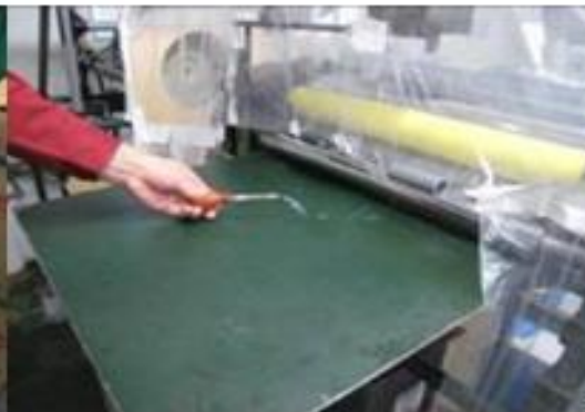
【写真4】印刷機に設置した密閉式囲い。スモークテスターからの煙は、勢いよくダクトに吸い込まれる。
