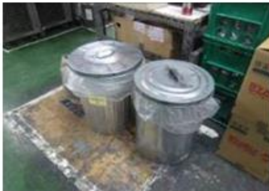
【写真3】使用済みウエスはフタ付き容器に格納されている。
