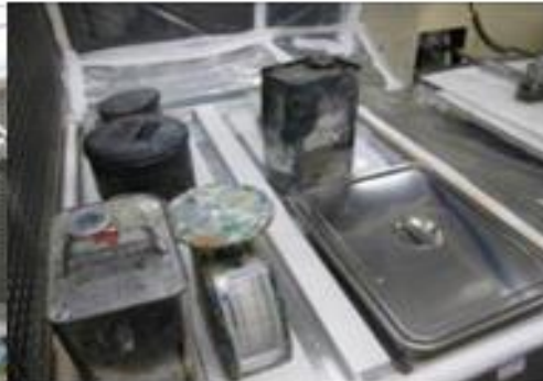
【写真2】インク用バットは蓋つきとした。他の溶剤容器もプッシュプル換気エリア内に置いた。
