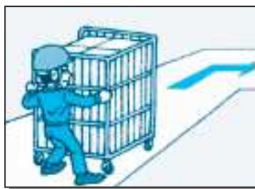
・長距離を移動しての停止 ・カーブを曲がる時は2 m手前で減速
