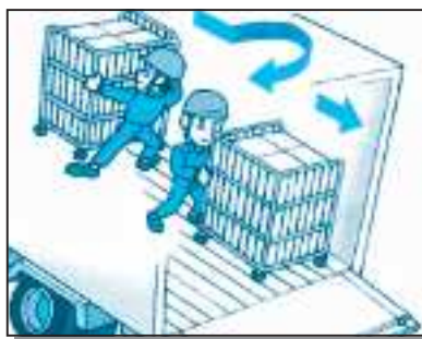
押せる位置まで引き出し、 その後押しながら移動
