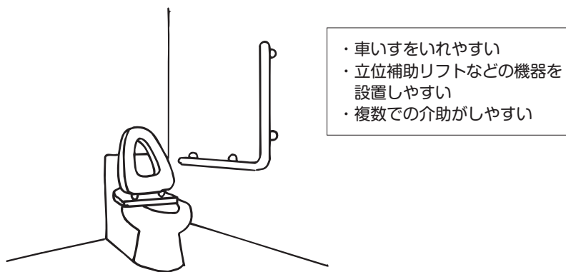
図6-2-15 広い空間が確保されたトイレ
