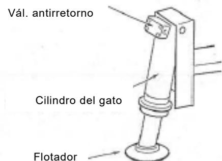
Fig.2-11 Estabilizador tipo A
