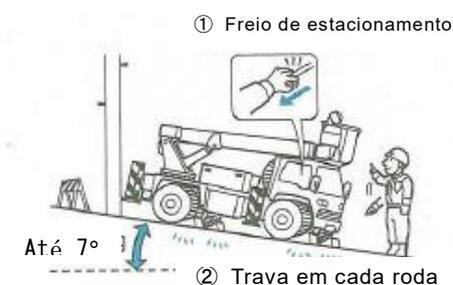
Imagem 2-42 Instalação da plataforma aérea veicular em terreno inclinado
