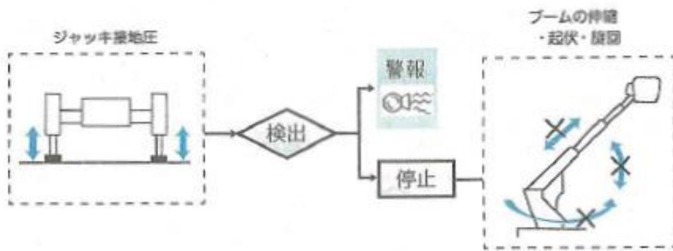
図 2-34 アウトリガーインターロック装置の作動例
