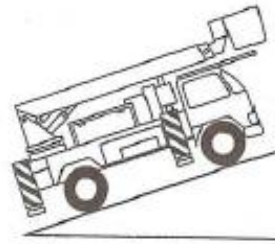
図 4-33 急傾斜での停車状態
