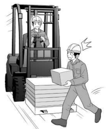
เวลาที่จะเดินผ่าน ขอให้ตรวจสอบ ยืนยันว่ารถโฟล์คลิฟท์ได้หยุดแล้ว และส่งเสียงเรียกคนขับและให้ สัญญาณก่อนเสมอ
