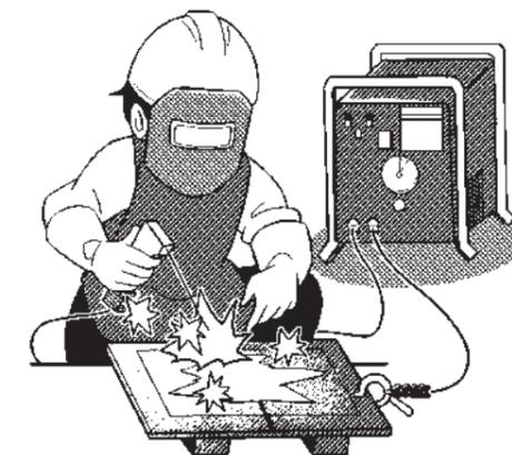
防止触电装置。交流弧焊（手弧焊）作业时，被现场负责人要求使用时，务必使用。
