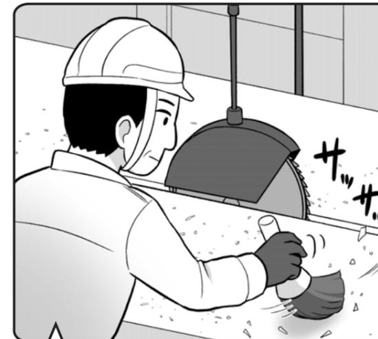
Desligue a máquina quando for remover lascas de madeira e serragem.
