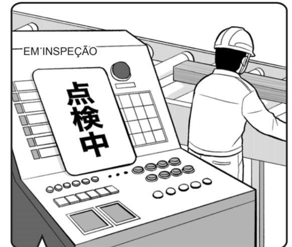
Desligue a máquina e coloque uma placa quando for resolver um problema.
