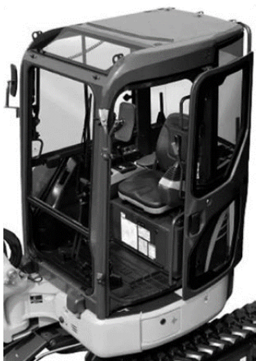
Зураг 3-9 Унах үеийн хамгаалах бүтэц (ROPS) бүхий тээврийн хэрэгсэлд суурилсан барилгын машин механизм
