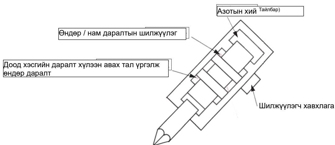
Зураг. 4-6 Гидравликийн шууд хөдөлгөх төрлийн (a) ажиллагааны схемийн жишээ
