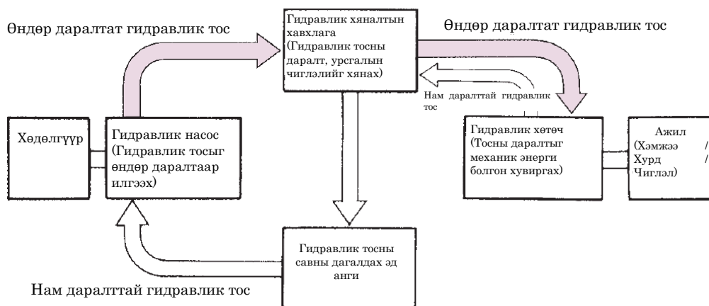
Зураг.2-9 Гидравлик төхөөрөмжийн механизмын танилцуулга
