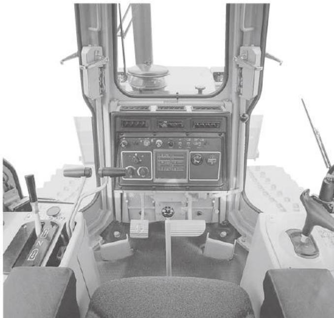
Foto 6-1 Ejemplo de dispositivo de operación de una topadora
