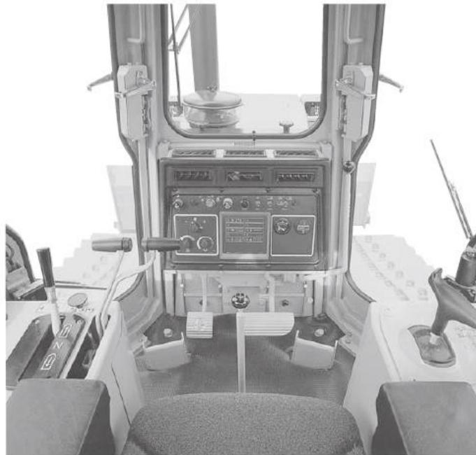
Foto 6-1 Ejemplo de equipo de operación de una topadora
