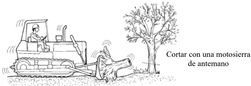
Figura 6-18 Ejemplo de trabajo de eliminación de raíces y hierbas
