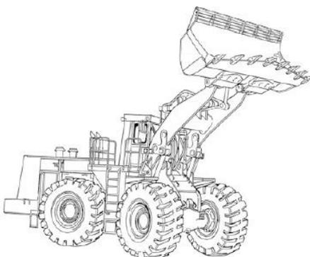
Figura 5-11 Ejemplo de tractor con pala (shoberu)
