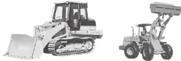
Foto 1-2 Ejemplo de tractor con pala
