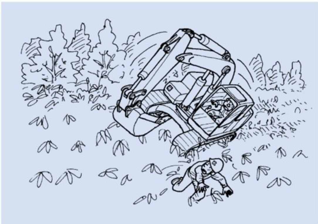
Una pala de arrastre (doragu shoberu) se movía a través de una pendiente de arbustos de bambú (aproximadamente 20 grados de pendiente) para realizar un modelado irregular del terreno en un área de descanso designada después de completar el trabajo de drenaje de agua en el sitio de excavación. Al hacerlo, la pala de arrastre (doragu shoberu) se cayó y un trabajador de obra que estaba guiando quedó atrapado debajo de la pala de arrastre (doragu shoberu).
