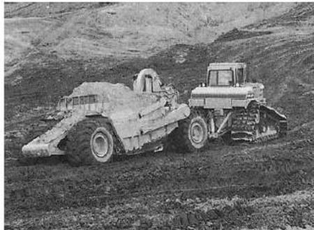
Foto 6-6 Condición de operación de la trailla remolcada
