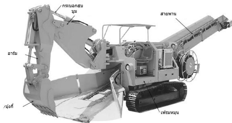
ภาพที่ 5-25 ตัวอย่างอุปกรณ์การทำงานของรถดักแบบขุด
