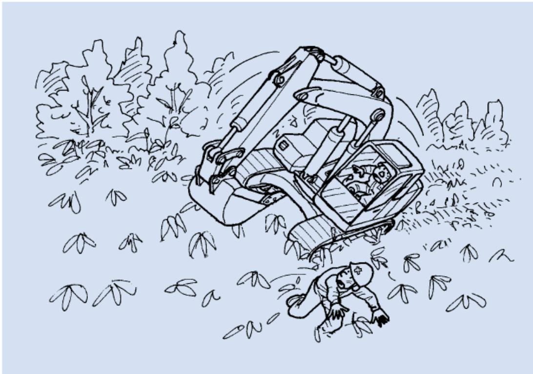
No local da escavação, a escavadeira de arrasto, que havia concluído a obra de drenagem, estava se deslocando pelo terreno inclinado com bambuzal (declive de 20 graus) para realizar os trabalhos de modelagem de terreno intransitável da área determinada para o local de descanso.
