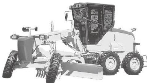
Foto 1-5 Exemplo de motoniveladora
