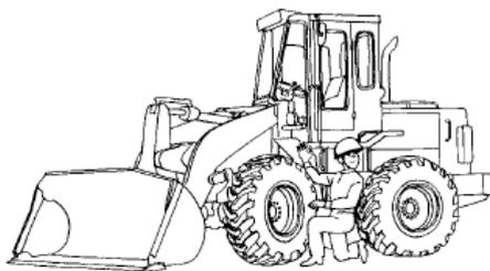
Figura 7-5 Inspeção de pneus
