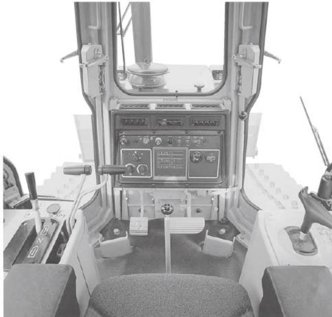
Foto 6-1 Exemplo de dispositivo operacional de bulldozer
