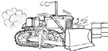
Figura 8-1 Motor desligado ao deixar o assento
