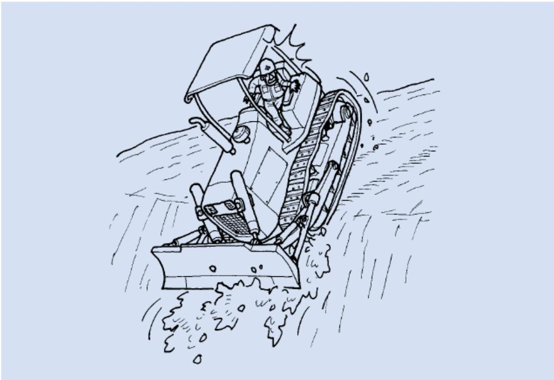
Durante o trabalho de recorte da ladeira (nori men), estava fazendo o trabalho de terraplanagem empurrando a terra para nivelar com buldôzer, e caiu da extremidade frontal da obra junto com buldôzer e ficou prensado embaixo da máquina.
