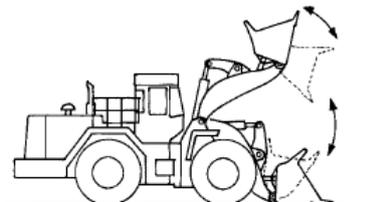
Figura 6-30 Exemplo de operação do braço de elevação e da caçamba
