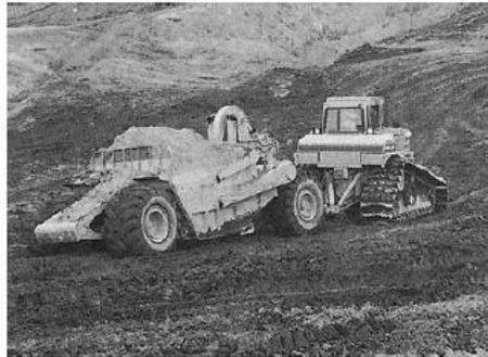
Foto 6-6 Estado de trabalho do raspador tipo rebocado
