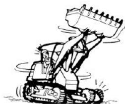
Figura 4-3 Precauções ao girar in situ em alta velocidade
