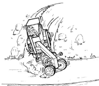
Figura 9-19 Capotamento devido à força centrífuga
