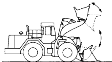
그림 6-30 리프트 암과 버킷의 조작 예시
